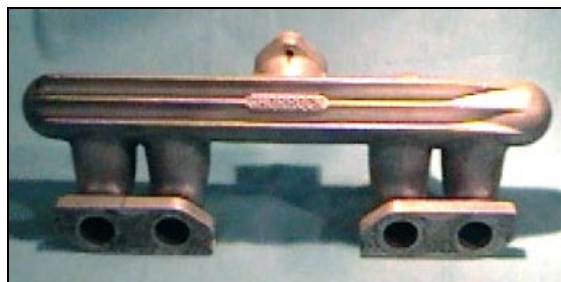
FORD 105E INLET MANIFOLD NO CNM 012
